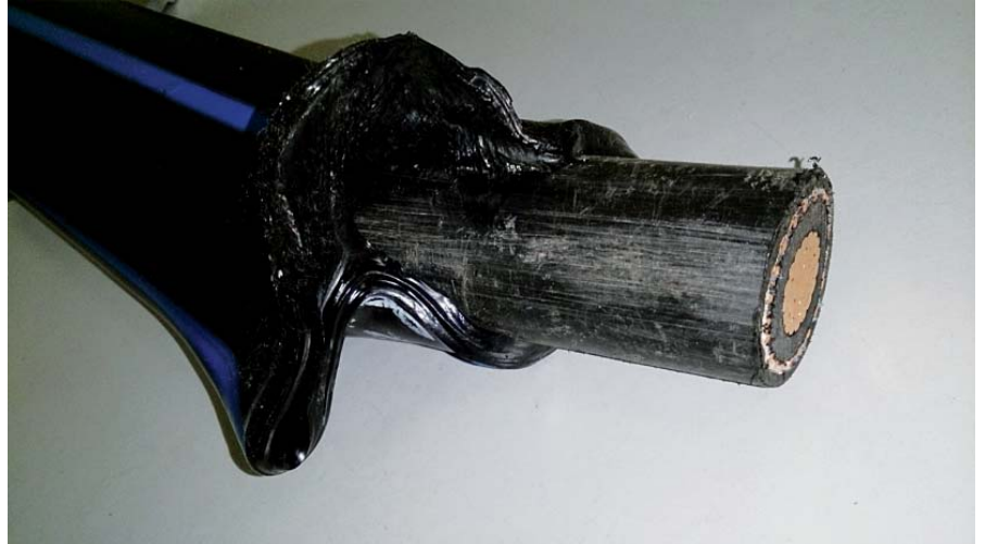
Рис. 7. Прилипание ПНД-трубы к поверхности оболочки однофазного кабеля
