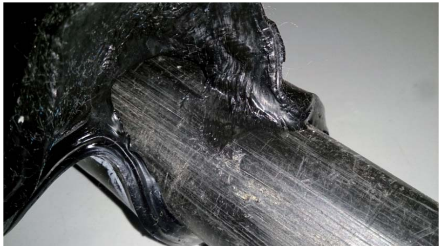
Рис. 7. Прилипание ПНД-трубы к поверхности оболочки однофазного кабеля
